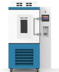
Отличаются отличной точностью и равномерностью распределения температуры. Укомплектованы стеклом с антизапотевающим покрытием. Мощный интерфейс позволяет отобразить процесс работы оборудования в нескольких вариантах. Установка SD-карты позволяет записывать процесс в режиме реального времени.
