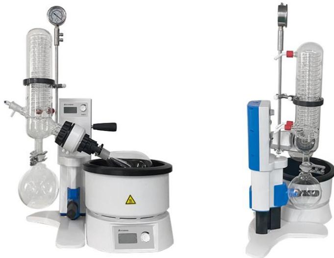
Ротационный испаритель — это быстрый и эффективный концентратор, использующий вакуумную декомпрессию, площадь поверхности и тонкопленочное испарение.
