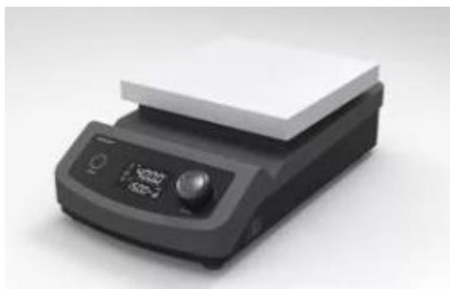
Предназначена для перемешивания жидкостей в лабораторных условиях. Современная модель SH-HSD является наиболее популярной мешалкой с подогревом. Отличается превосходным распределением температуры на поверхности плиты. Может работать в трёх режимах - "нагревание", перемешивание" и нагревание + перемешивание". Керамические пластины со специальным покрытием обеспечивают превосходную устойчивость поверхности к агрессивным жидкостям.
